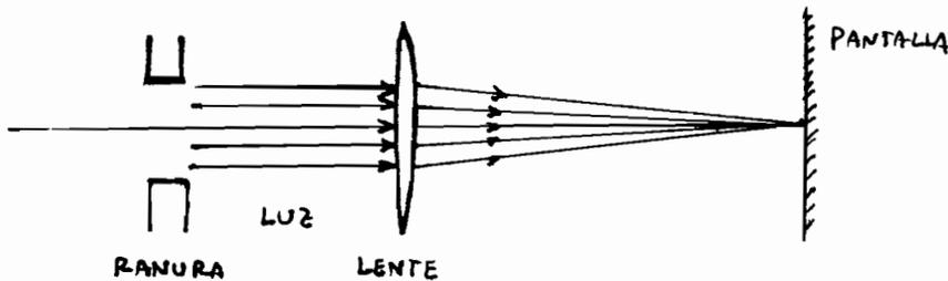
A ESTE TIPO DE DIFRACCIÓN EN DONDE SE COLOCA UNA LENTE PARA QUE LOS RAYOS CONVERJAN EN LA PANTALLA, SE LA LLAMA DIFRACCIÓN DE FRAUNHOFER. HAYA LENTE O NO HAYA LENTE PUEDO ESQUEMATIZAR LO QUE PLANTEA EL PROBLEMA ASÍ:
