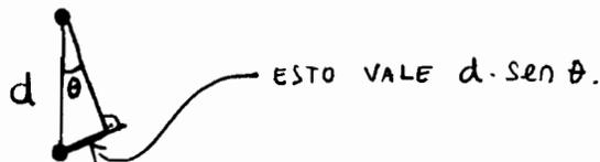
EN REALIDAD PARA QUE HAYA INTERFERENCIA DESTRUCTIVA, LA DISTANCIA  $d \cdot \text{sen } \theta$  NO TIENE QUE SER IGUAL <sup>SÓLO</sup> A MEDIA LONGITUD DE ONDA. PUEDE SER IGUAL A  $3 \lambda/2$   $\sigma$   $5 \lambda/2$   $\sigma$  UN NÚMERO IMPAR DE MEDIAS LONGITUDES DE ONDA.
