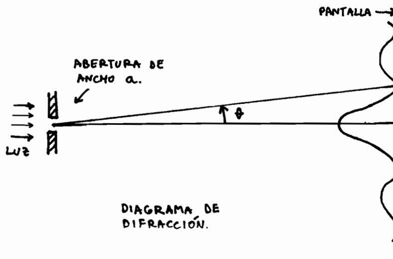
ESTE GRÁFICO MUESTRA COMO VARÍA LA INTENSIDAD DE LA LUZ QUE PEGA EN LA PANTALLA EN FUNCIÓN DEL ÁNGULO TITA, O LO QUE ES LO MISMO, DE LA DISTANCIA AL MÁXIMO CENTRAL. SE LO SUELE LLAMAR FIGURA DE DIFRACCIÓN, DIAGRAMA DE DIFRACCIÓN O PATRÓN DE DIFRACCIÓN. (PATRÓN EN ESTE CASO SIGNIFICA DIBUJO O DISEÑO).
