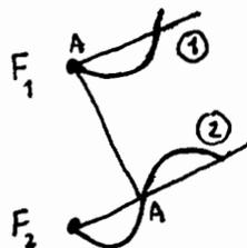
A PARTIR DE LA LÍNEA A-LA LAS ONDAS ① y ② TIENEN UN  $\Delta C_o$  DE  $\lambda/2$  Y UN DESFASAJE  $\varphi$  DE  $180^\circ$  ( $\pi$ ).
