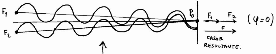
LAS 2 ONDAS LLEGAN SIN DESFAJAJE AL PUNTO CENTRAL DE LA PANTALLA Y DAN UN MÁXIMO. LOS DOS FASORES FORMAN UN ÁNGULO DE  $0^\circ$  ENTRE SÍ (PORQUE  $\varphi=0$ ).
